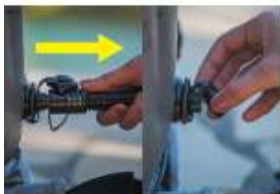
7) Entfernen Sie den Füllschlauch und schließen Sie das Luftventil.
