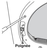
12. Placez-vous du côté droit de l'appareil et serrez les deux vis maintenant le châssis avant et les deux vis maintenant la poignée.
