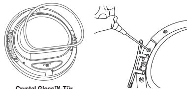
5. Drehen Sie anschließend das Türscharnier und den Türgriff (wie in der Abbildung gezeigt) um 180°.
