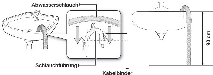
2. Bringen Sie den Abwasserschlauch und die Schlauchführung an, und befestigen Sie sie mit dem Kabelbinder.
