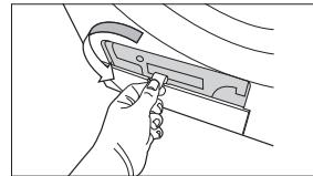
2. Öffnen Sie den Befestigungshebel des Kondensators.
