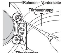
4. Entfernen Sie die 16 Schrauben.
