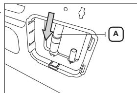
3. Schließen Sie den Zubehörschlauch (langer Abwasserschlauch) **B** an den Stutzen neben dem an, an den der Abwasserschlauch angeschlossen ist **A**.
