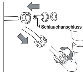
2. Schließen Sie das Schlauchende an den Abwasserstutzen an.
