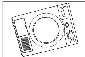
2. Bringen Sie die Gummipolster auf der Unterseite des Geräts an.
