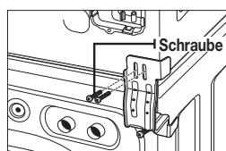
5. Stellen Sie den Trockner mit den Klammern auf die Waschmaschine.
