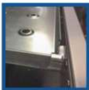
Placera plattformarna över kanten.
