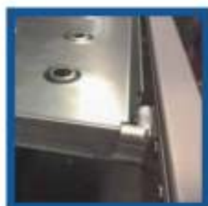
Posizionare le piattaforme sopra il bordo.
