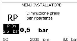
Figura 17: Impostazione della pressione di ripartenza
