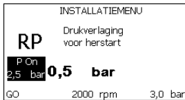
Afb. 17: Instelling van de herstartdruk
