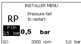
Рисунок 17: Настройка давления нового включения
