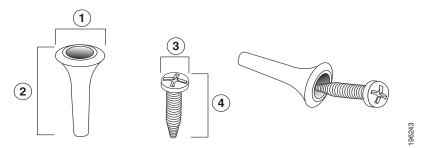
**1** 0.4 in/8 mm **2** 0.9 in/22.2 mm **3** 0.3 in/6.8 mm **4** 0.7 in/17.6 mm
