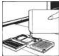
El depósito de detergente está dentro de la puerta. La tapa del depósito debe cerrarse antes de cada lavado. Para abrirla, simplemente presione el cierre. Al finalizar cada ciclo de lavado la tapa del depósito siempre queda abierta y lista para la siguiente utilización del lavavajillas.
