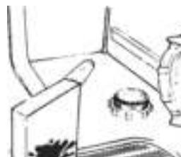
Para añadir la sal, desenrosque la tapa del depósito de sal que se encuentra en el fondo y rellénelo. Durante esta operación se derramará un poco de agua, pero siga añadiendo la sal hasta llenar el depósito, limpie los residuos de sal y apriete la tapa.
