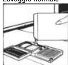
La vaschetta per il detersivo del lavaggio è situata all'interno della porta. Se il coperchio del contenitore risultasse chiuso, per aprirlo basta premere sul pulsante di aggancio : al termine di un qualsiasi programma di lavaggio il coperchio risulta sempre aperto, pronto per il successivo impiego.
