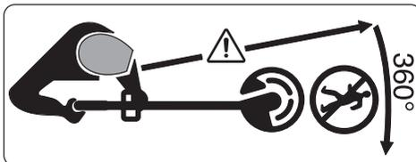
Varmista, että sivulle sinkoutuvat vieraat esineet eivät loukkaa lähellä seisovia ihmisiä.
