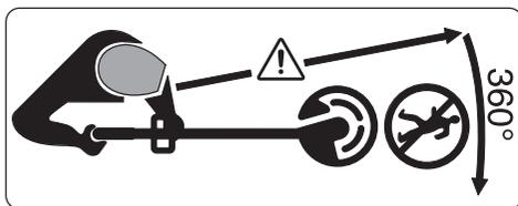
Se till att personer, som befinner sig i närheten inte skadas av ivägslungade främmande föremål.
