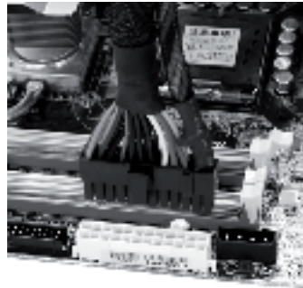
ATX 20+4 connector met gescheiden 4 pin connector (linkerafbeelding) en gecombineerd (rechteraafbeelding).
