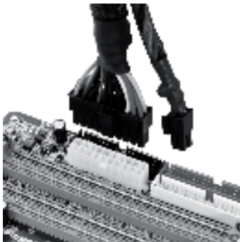
4 poliger ATX 20+4-Stecker einzeln (linkes Bild) und montiert (rechtes Bild)
