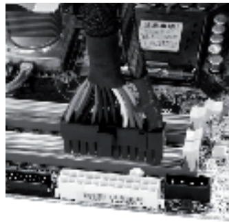
Connettore ATX 20+4 con connettore a 4 pin non inseriti (immagine a sinistra) e inseriti (immagine a destra)
