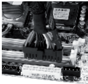
4 poliger ATX 20+4-Stecker einzeln (linkes Bild) und montiert (rechtes Bild)
