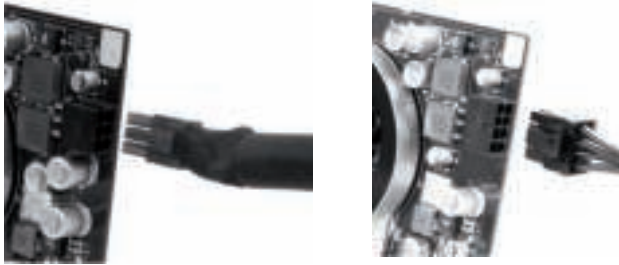
PCI-E 6+2 -piikkinen liitin erillisellä 2 -piikkisellä liittimellä (kuva vasemmalla) ja liitetty (kuva oikealla) VGA-korttia varten.
