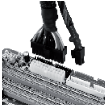
ATX 20+4 csatlakozó 4-tűs csatlakozóval, leválasztva (bal oldali kép) és csatlakoztatva (jobb oldali kép)
