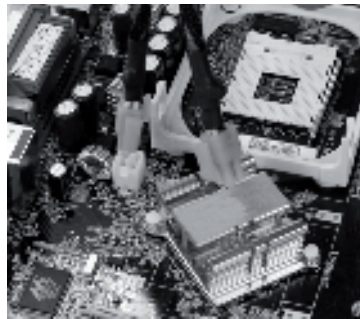
ATX12V 4+4 connector gecombineerd (linkerafbeelding) en gescheiden (rechteraafbeelding).
