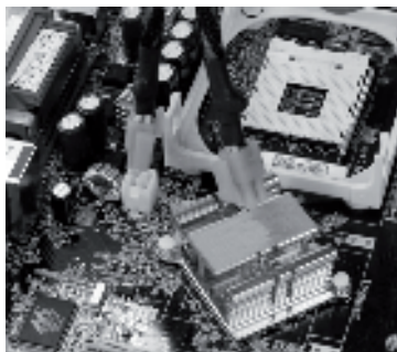
Conector ATX12V 4+4 combinat (poza din stânga) și separat (poza din dreapta).
