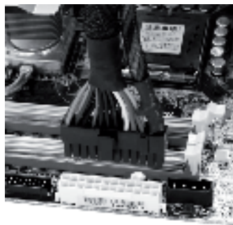
Konektor ATX 20+4 se 4pinovým konektorem odděleným (obrázek vlevo) a připevněným (obrázek vpravo)
