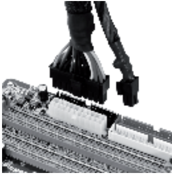
ATX 20+4 -liitin erillisellä 4 piikkisellä liittimellä (kuva vasemmalla) ja liitetty (kuva oikealla).
