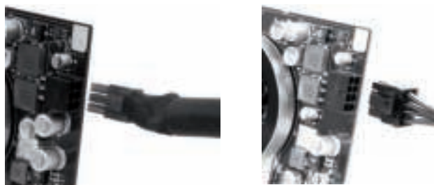
Konektor PCI-E 6+2 pinů s 2pinovým konektorem odděleným (obrázek vlevo) a připevněným (obrázek vpravo) pro VGA kartu
