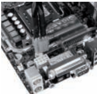
Connettore ATX12V 4+4 combinato (immagine a sinistra) e separato (immagine a destra)
