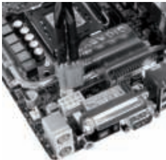
ATX12V 4+4 connector gecombineerd (linkerafbeelding) en gescheiden (rechteraafbeelding).
