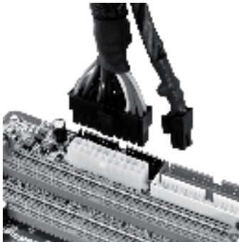
Connecteur ATX 20+4 avec connecteur à 4 broches séparées (image de gauche) et attachées (image de droite)
