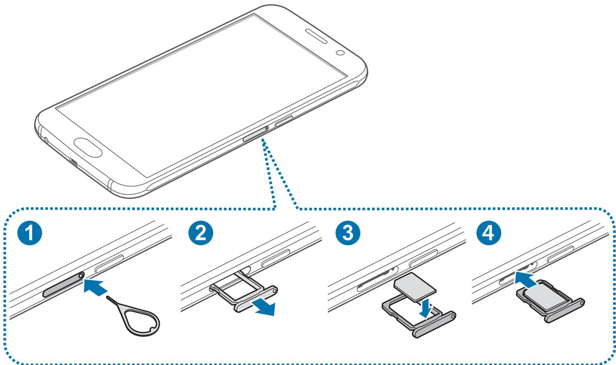
**1** Führen Sie das Steckplatzwerkzeug in die Öffnung am SIM-Kartenträger, um das Fach zu lösen.
