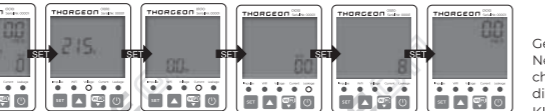
o Funktionsanzeige o Unterspannungs-/Überspannungseinstellung o Überstromeinstellung o Leckageeinstellung (Diese Funktion kann deaktiviert werden) o Zeiteinstellung für die Selbstrückstellung o Leistungsmesser
