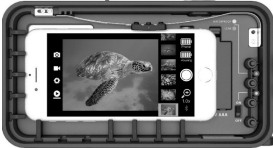
Kleine telefoon met grote rubberen greeplipjes geïnstalleerd
