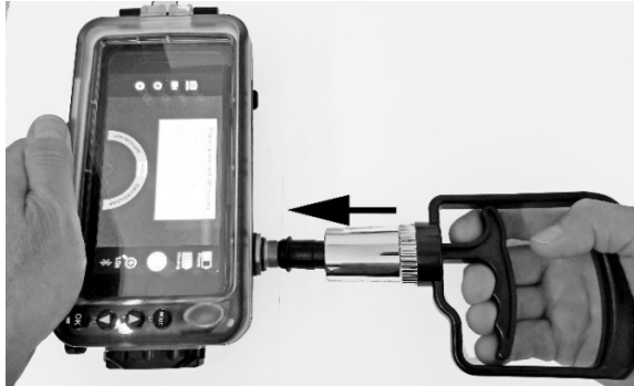
Handpomp tegen vacuümcontrolepoort gedrukt
