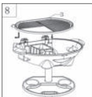
De opwarmingsplaat (het rooster) (3) op het corpus plaatsen (5). Plaats vooral het elektrische stopcontact (15) in de opening die ervoor bedoeld is (12), en plaat de plaat vervolgens horizontaal op het corpus.
