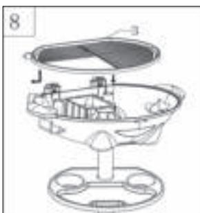
Die Grillplatte (Rust) (3) auf dem Anlagengehäuse (5) anbringen. Vor allem die Steckdose (15) in die für sie vorgesehene Öffnung (12) einstecken, dann die Grillplatte horizontal auf dem Anlagengehäuse anbringen.
