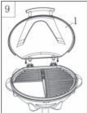
Installer le couvercle du grill en métal (1) sur le corps (5). (si le grill est à utiliser en plein air, mettre le couvercle de façon à ce qu'il protège l'appareil contre le vent)
