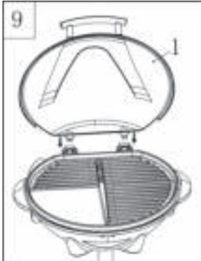
Den Metall-Grilldeckel (1) auf dem Anlagengehäuse (5) anbringen (wird der Grill im Freien genutzt, den Deckel so stellen, damit er einen Windschutz bildet).
