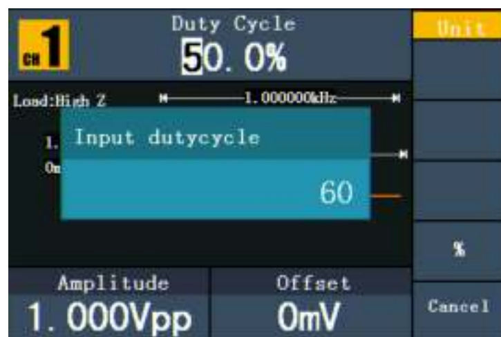
Abb. 0-8: Einstellen des Tastverhältnisses eines Rechteck-Signals
