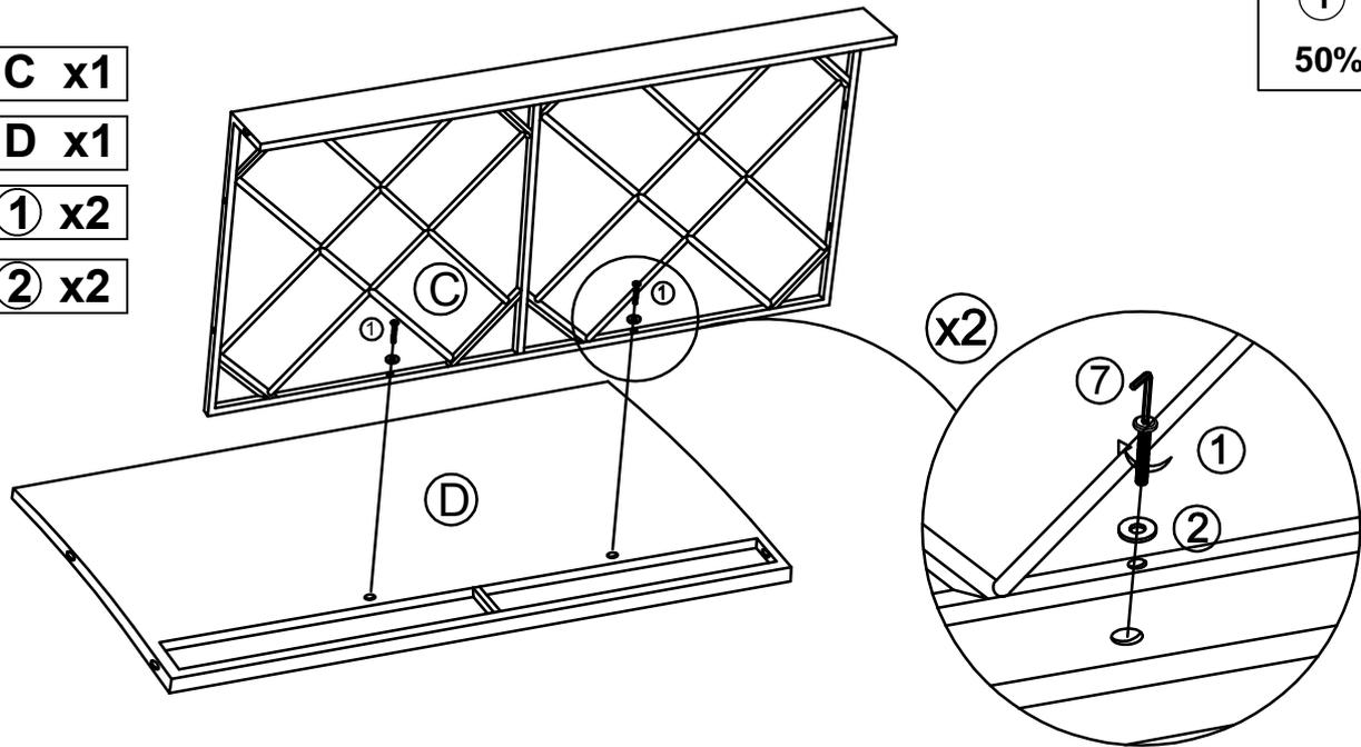
Push & Connect Sitz (C) & Hinterer Rahmen (D), Schraube festziehen (1) & U-Scheibe (2) with Allen Schlüssel (7).
