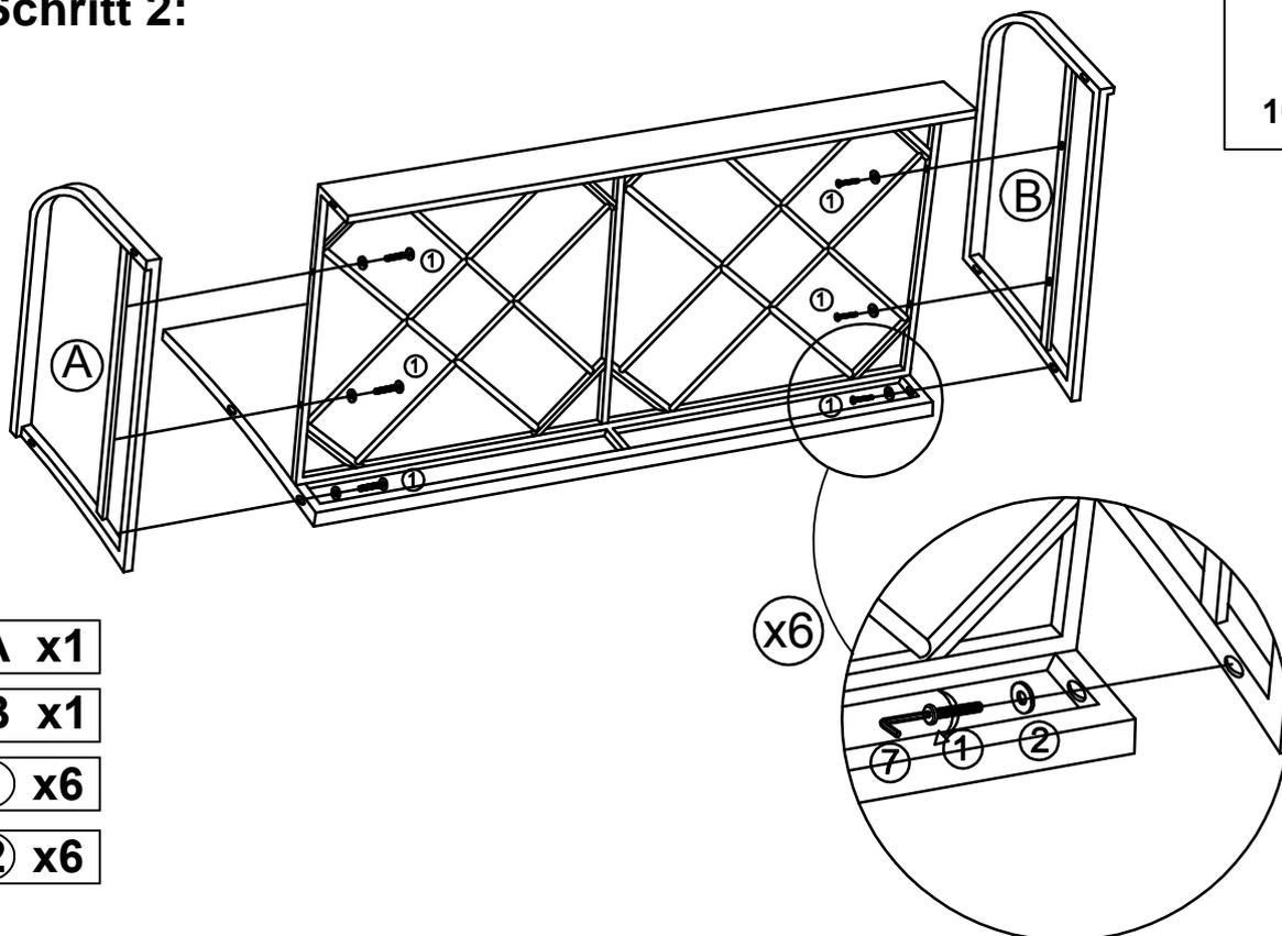
Verbinden Sie das Teil von Schritt 1 & Rechter Arm (A) & Linker Arm (B), Schraube festziehen (1) & U-Scheibe (2) with Allen Schlüssel (7).
