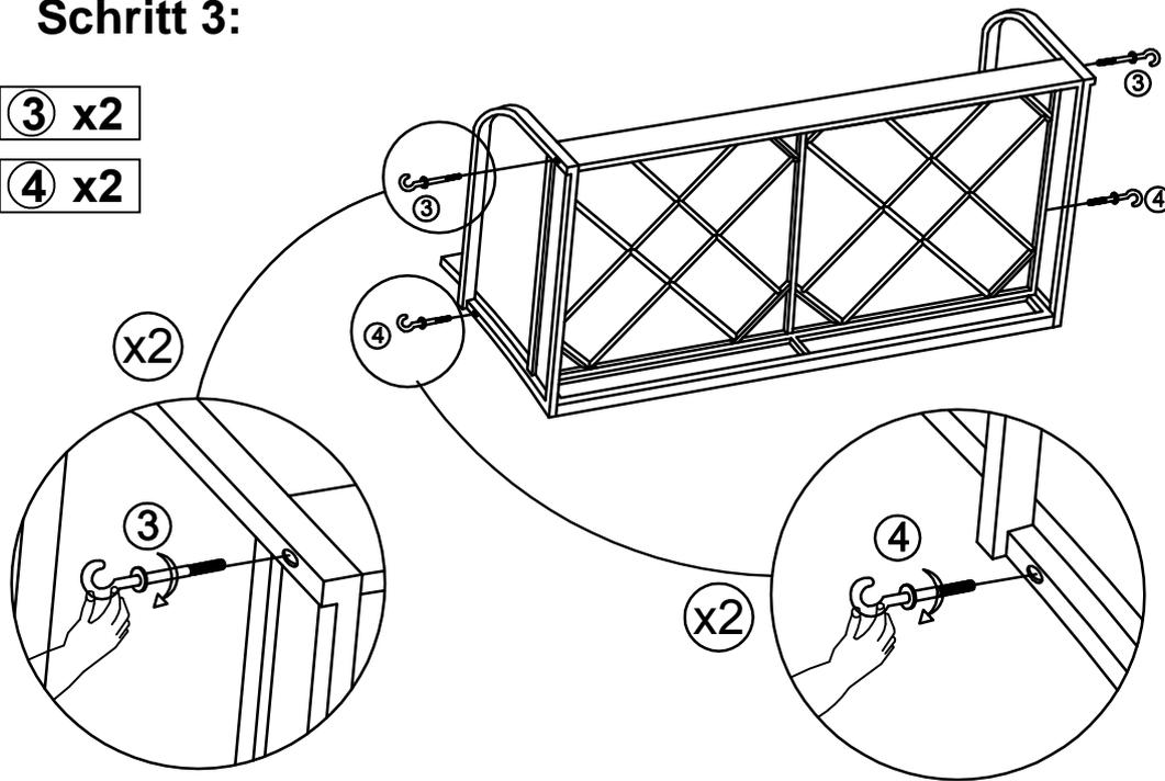
Verbinden Sie das Teil von Schritt 2 & tighten Haken (3) & Haken (4).
