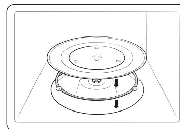
Retirez tout élément d'emballage de l'intérieur du four. Installez l'anneau de guidage et le plateau. Vérifiez que le plateau tourne librement.
