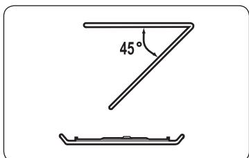
Om de bovenkant van de ovenruimte te reinigen, klap u het bovenste verwarmingselement 45° omlaag, zoals wordt weergegeven. Dit helpt om de bovenkant te reinigen. Wanneer u klaar bent, plaatst u het bovenste verwarmingselement terug.
