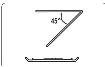
Pour nettoyer la zone supérieure du compartiment de cuisson, abaissez l'élément chauffant supérieur de 45°, comme indiqué. Cela permettra de nettoyer la zone supérieure. Une fois cela fait, repositionnez l'élément chauffant supérieur.
