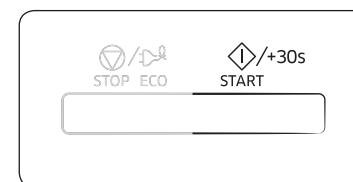
Drücken Sie die Taste **START/+30s**, und stellen Sie durch mehrmaliges Drücken der Taste **START/+30s** eine Garzeit von 4 oder 5 Minuten ein. Das Wasser wird im Gerät 4 bis 5 Minuten lang erhitzt. Es sollte anschließend sieden.
