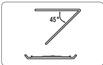
Klappen Sie das Heizelement zum Reinigen der Garraumdecke um 45° nach unten (siehe Abbildung). So können Sie die Decke des Garraums einfacher reinigen. Klappen Sie das Heizelement anschließend wieder nach oben.
