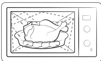
1. Die vom Magnetron erzeugten Mikrowellen werden im Innern des Garraums reflektiert und gleichmäßig verteilt, während sich die Speisen auf dem Drehteller drehen. So werden die Lebensmittel gleichmäßig erhitzt.
