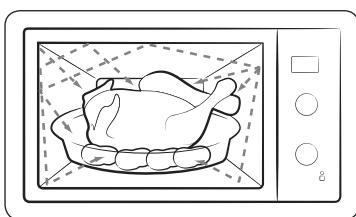
1. De microgolven die door de magnetron worden gegenereerd, worden binnen de ovenruimte heen en weer gekaats en gelijkmataig verspreid terwijl het gerecht op het draaiplateau ronddraait. Hierdoor wordt het gerecht gelijkmataig verwarmd.
