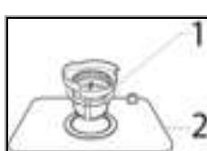
Le système de filtrage permet d'éviter que de grandes quantités d'aliments ou que d'autres objets ne pénètrent dans la
