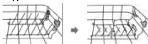
Le support à tasses/à assiettes peut être replié pour permettre la disposition de plats encombrants.
