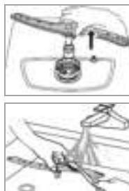
Kamień i zanieczyszczenia z wody zmywającej mogą blokować dysze i łożyska ramienia spryskiwacza. Regularnie sprawdzaj dysze wylotowe ramienia spryskiwacza pod względem zatorów.
