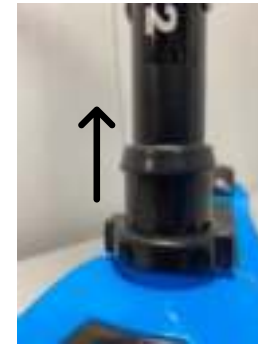
5. Trek de hendel omhoog om de stuurstang weer te kunnen inklappen.
