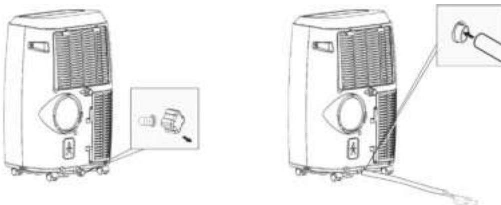
Figure 7 Écoulement de la cuve de sol
