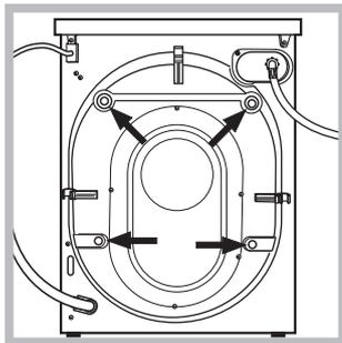
3. Die 4 Transportschutzschrauben herausschrauben und die an der Gerätrückwand befindlichen Distanzstücke aus Gummi entfernen (siehe Abbildung).
