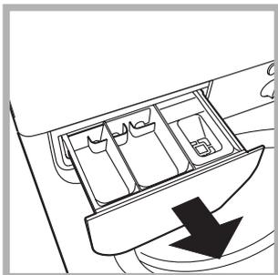
Verwijder het bakje door het op te lichten en naar voren te trekken (zie afbeelding). Was het onder stromend water. Dit moet u regelmatig doen.
