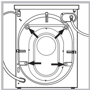
3. Verwijder de 4 schroeven die het apparaat beschermen tijdens het vervoer en de rubberen ring met bijbehorende afstandslider die zich aan de achterkant bevinden (zie afbeelding).
