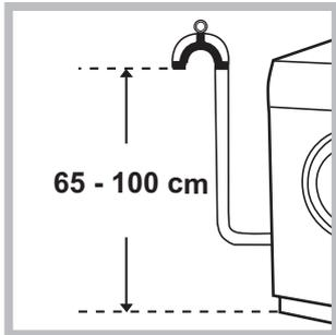
Verbind de buīs, zonder hem te buigen, aan een afvoerleiding of aan een afvoer in de muur tussen de 65 en 100 cm van de grond
