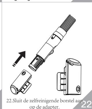
22. Sluit de zelfreinigende borstel aan op de adapter.
