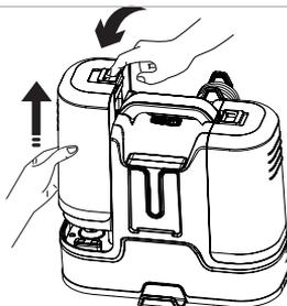
1. Verwijder de vieswatertank verticaal door aan de knop van de tank te trekken.
