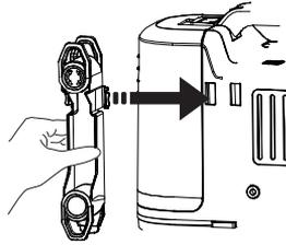
1. Bevestig het snoer met snelsluiting door deze in de gleuf linksachter op de machine te klikken
