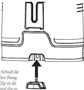
6. Schuif de Flex Slang Clip in de sleuf die te vinden is aan de voorkant van de machine. U moet een "klik" horen als hij vastzit.
