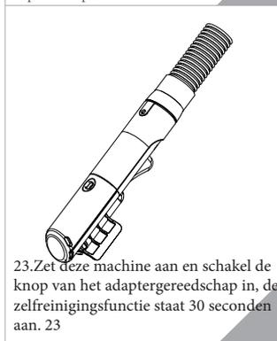
23. Zet deze machine aan en schakel de knop van het adaptergereedschap in, de zelfreinigingsfunctie staat 30 seconden aan. 23
