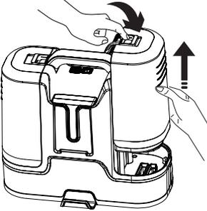
3. Verwijder de vieswatertank verticaal door aan de knop van de tank te trekken.
