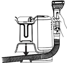
7. Wikkel de flexibele slang rond de machine en klik de slangklem in de houder.
