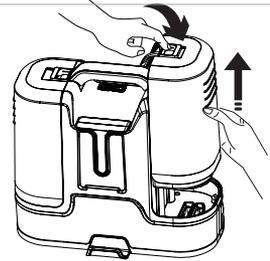
2. Verwijder de schoonwatertank verticaal door aan de knop van de tank te trekken.
