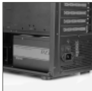
Netzteil platzieren Place power supply
