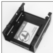
Platzieren Sie die SSD und befestigen Sie sie mit 4 Schrauben. Place the SSD and fix it with 4 screws.
