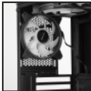
Lüfter hinter die Rückseite halten, Luftstrom beachten Hold fans behind the back side, follow airflow
