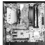
Mainboard befestigen Fix Mainboard
