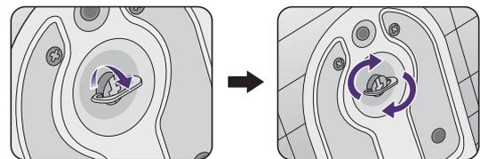
Oriente y alinee el enchufe el brazo de soporte con el monitor y presione uno con otro hasta que haga clic y encajen.
