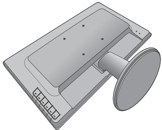
Inserte un objeto punzante como un destornillador en el orificio encima del brazo de soporte del monitor y luego empuje el destornillador contra el botón de liberación. A continuación tire del pedestal para separarlo del monitor.
