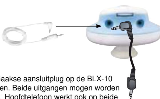
Alleen haakse aansluitplug op de BLX-10 aansluiten. Beide uitgangen mogen worden gebruikt. Hoofdtelefoon werkt ook op beide aansluitingen
