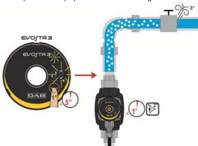
Figura 9: Purga automática de la bomba
