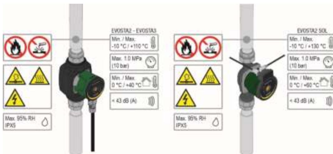
Рисунок 1: Перекачиваемые жидкости, предупреждения и условия эксплуатации
