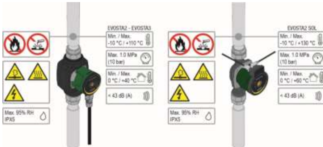
Image 1: Liquides pompés, avertissements et conditions de fonctionnement
