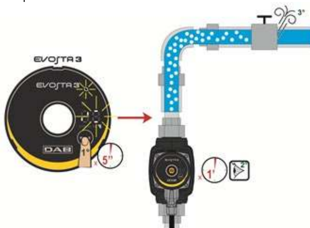
Рисунок 9: Автоматическое удаление воздуха из насоса
