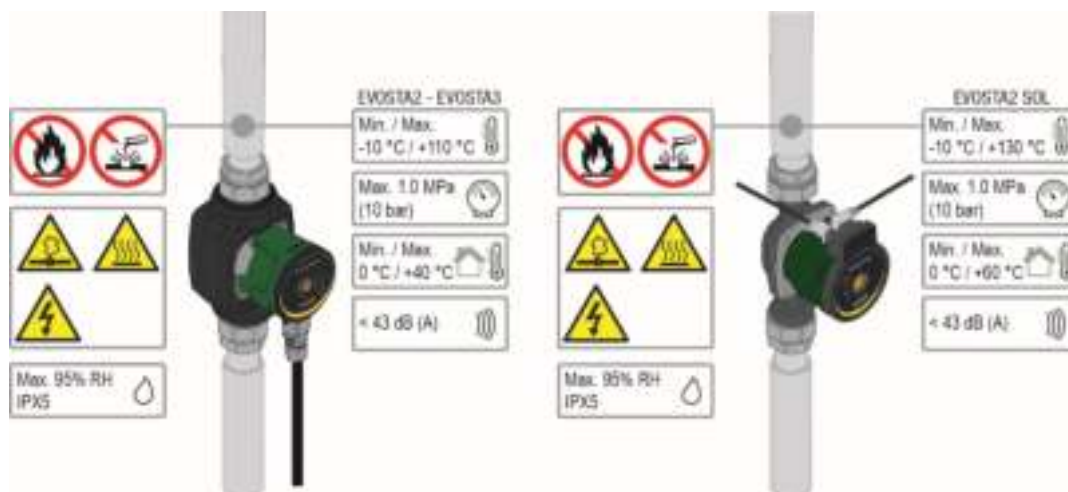
Fig 1: Vätskor, varningar och driftförhållanden
