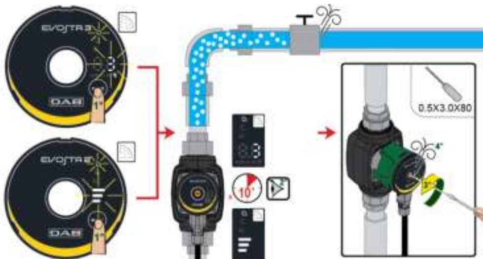
Figura 8: Drenagem da bomba
