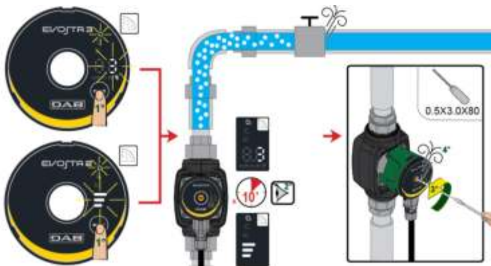
Рисунок 8: Удаление воздуха из насоса
