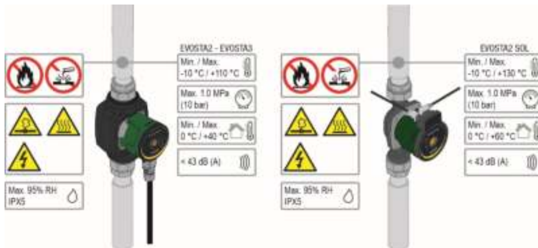
Figura 1: Liquidi pompati, avvisi e condizioni di funzionamento
