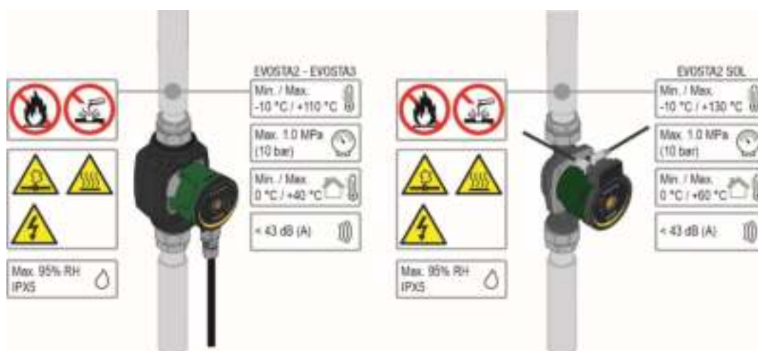
Slika 1: Črpane tekočine, opozorila in obratovalni pogoji
