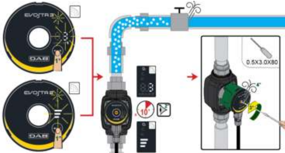
Fig. 8: Udluftning af pumpe
