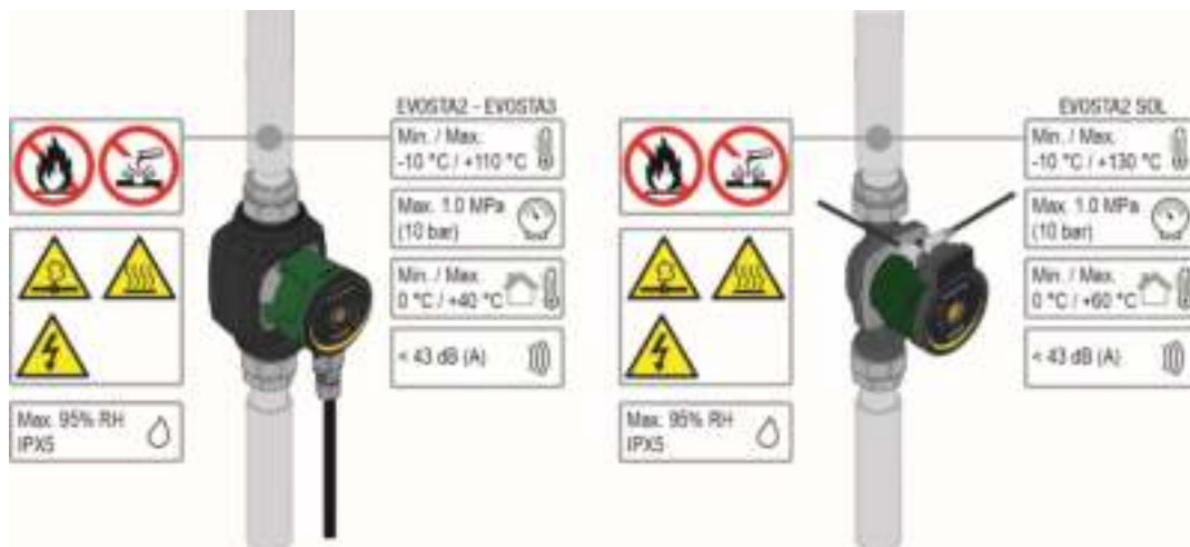
1. ábra: Szivattyúzott folyadékok, figyelmeztetések és működési feltételek
