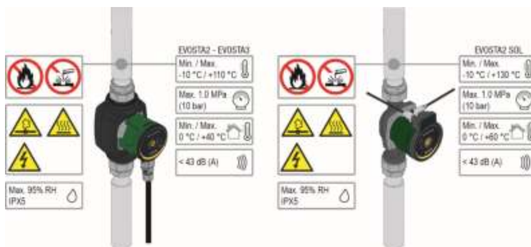
Obrázok 1: Čerpané kvapaliny, varovania a prevádzkové podmienky
