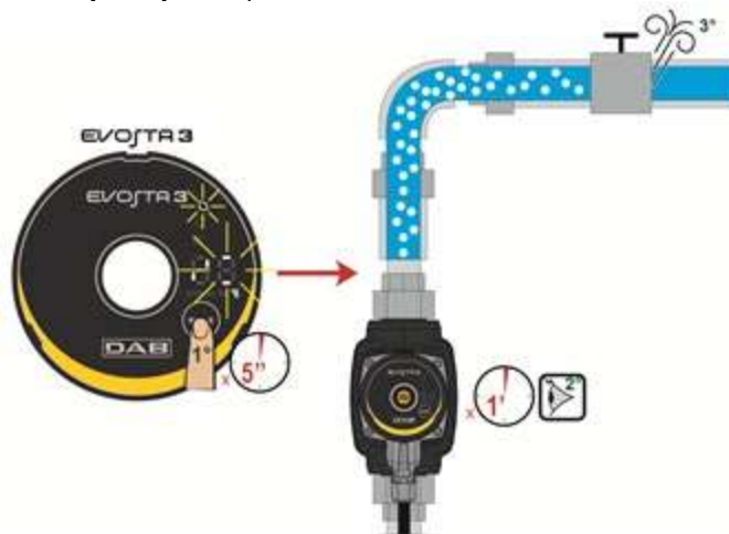
Kuva 9: Pumpun automaattinen ilmaus
