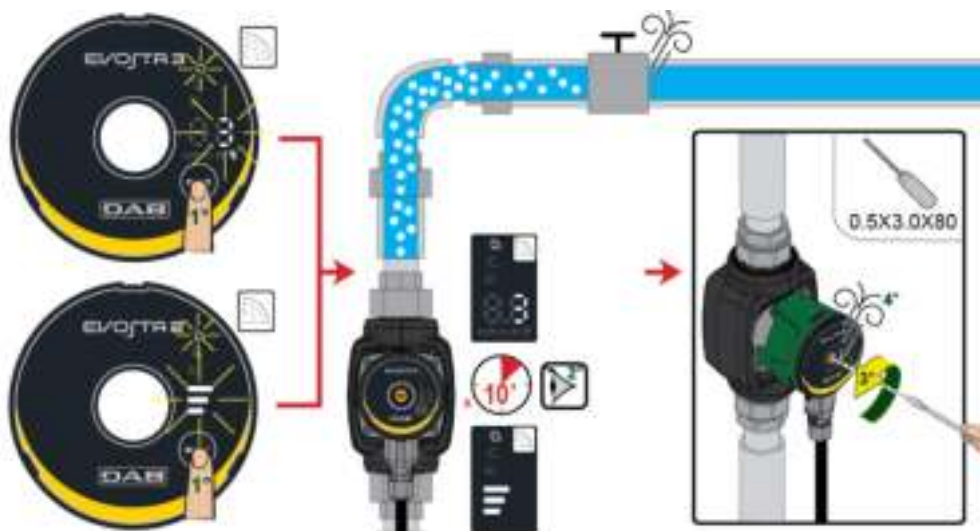
Rysunek 8: Odpowietrzenie pompy
