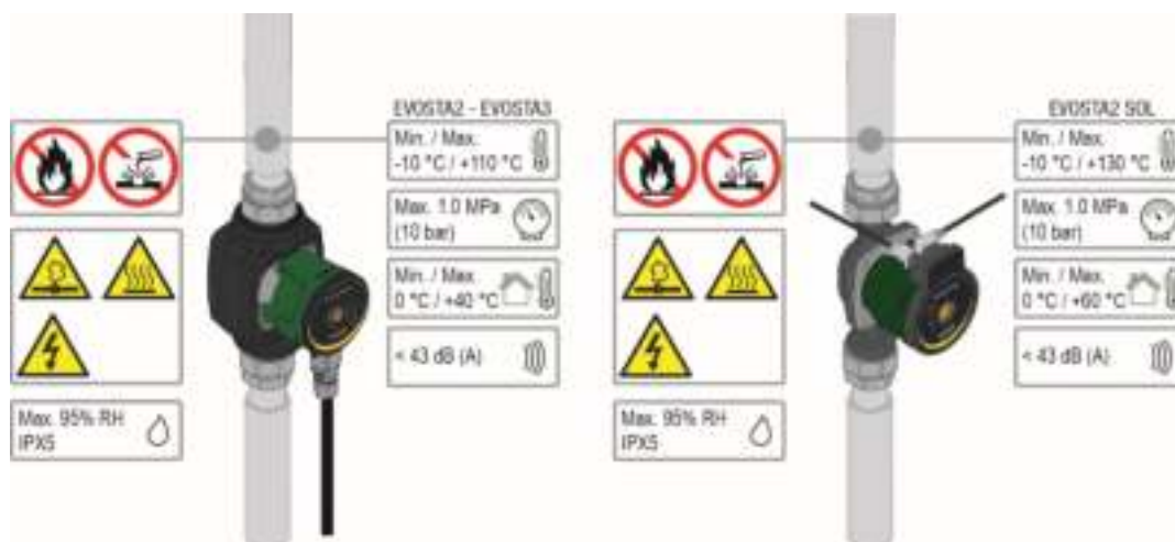
Obrázek 1: Čerpané kapaliny, varování a provozní podmínky
