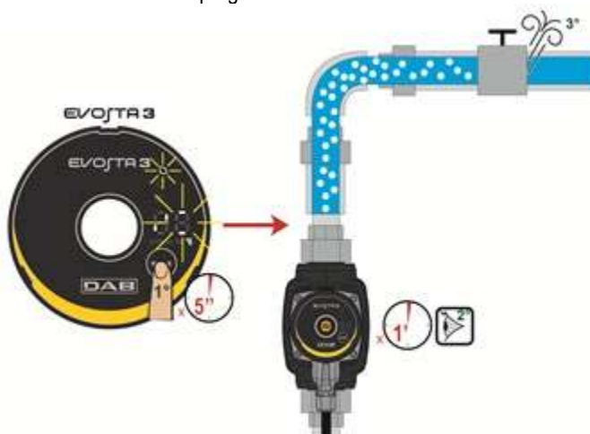
Figura 9: Drenagem automática da bomba
