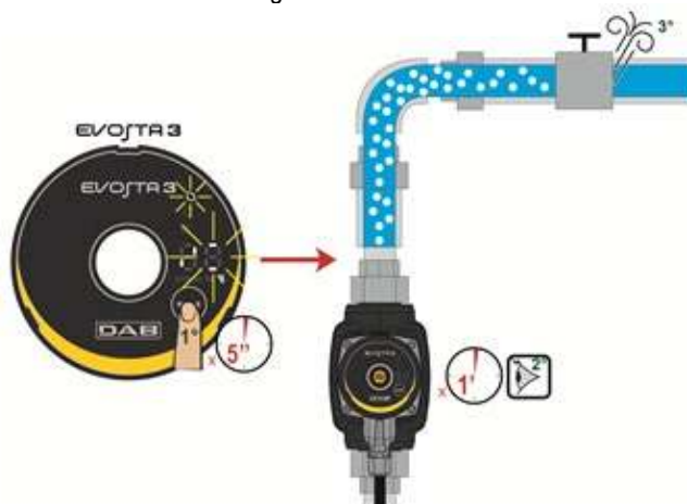
Image 9: Purge automatique de la pompe
