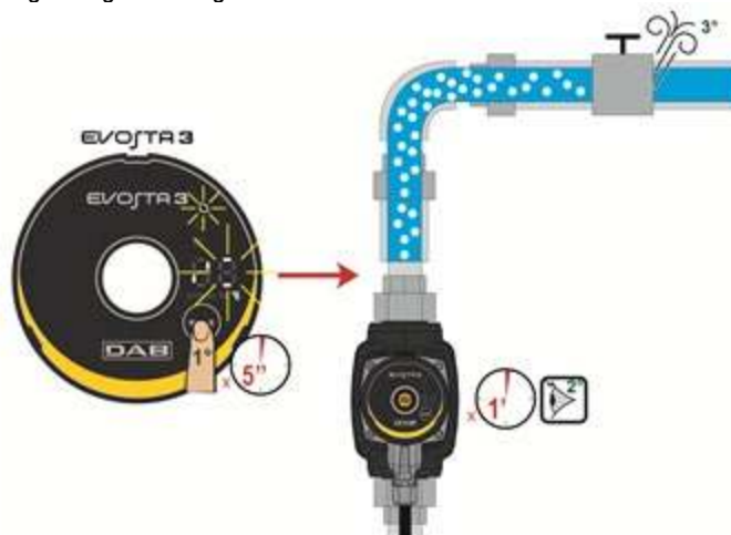
Fig. 9: Automatisk udluftning af pumpe
