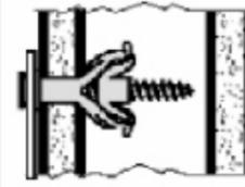
HOHLWÄNDE SPREIZDÜBEL FÜR VERANKERUNG AUS METALL
