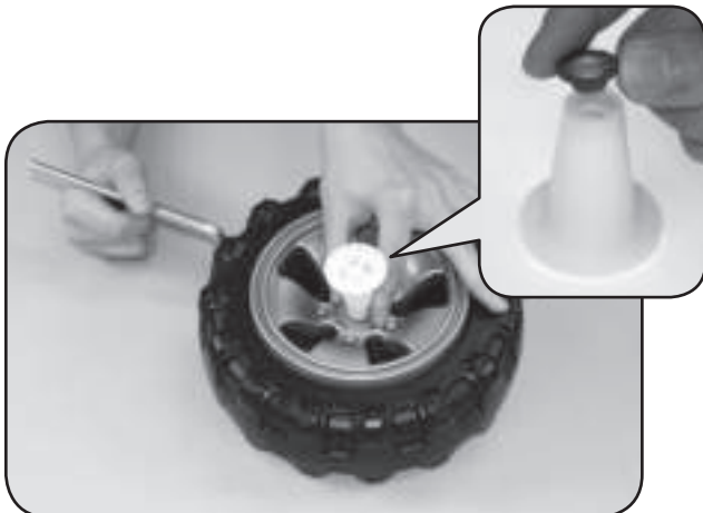
Place top hat tool with top hat onto open end of axle. Placez l'outil pour écrou borgne en mettant l'écrou borgne sur l'extrémité ouverte de l'essieu. Coloque el dispositivo para remate con el remate en el extremo libre del eje.
