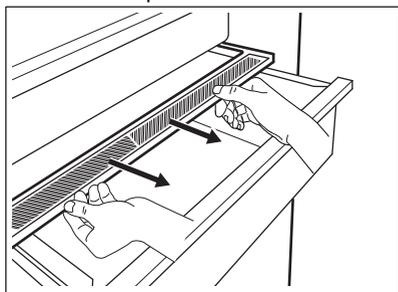
2. Se è necessario sostituire la membrana bianca del dispositivo, afferra il dispositivo al centro e separa la membrana dal coperchio tirando il coperchio.
