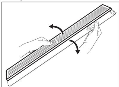
3. Monta una nuova membrana sul coperchio premendo il bordo della membrana sopra il coperchio.
