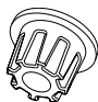
Espaçadores interi- ores para montagem na parede 4de cada (Apenas UC97**) (Consulte a p. 24)
