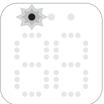
Prvý svetelný indikátor rýchlo bliká. Batéria je veľmi vybitá, zariadenie čoskoro prestane fungovať.
