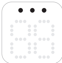
Všetky indikátory nepretržite svietia. Batéria je úplne nabitá.
