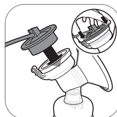
6. Pripojte silikónovú hadičku a viečko k silikónovej membráne. Tlačte na viečko, kým pevne nezapadne na miesto.
