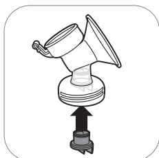
2. Zatlačte biely ventil čo najďalej do tela odsávačky.
