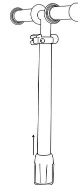
2. Tirez le mécanisme de pliage vers la T-barre jusqu'à ce que vous pouvez plier le guidon vers le bas.
