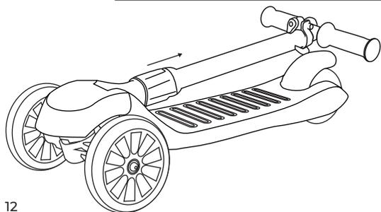
2. Tirez le mécanisme de pliage vers la T-barre jusqu'à ce que vous pouvez lever le guidon.
