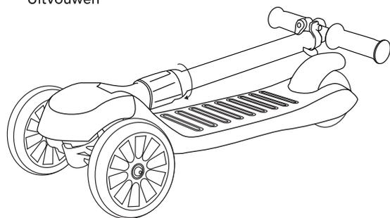
1. Ontgrendel het stuur door de knop met de klok mee te draaien
