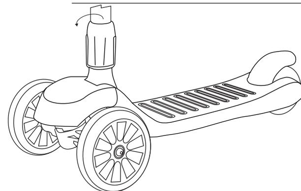
4. Draai de knop tegen de klok in om het stuur vast te zetten.
