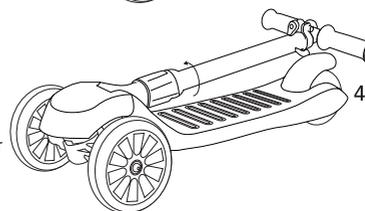
4. Draai de knop tegen de klok in om het stuur vast te zetten.
