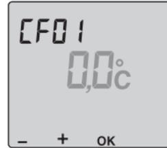
Wenn ein Unterschied zwischen Raumtemperatur und Anzeigetemperatur der Fernsteuerung auftritt, so kann der Fehler im Bereich von -4°C bis +4°C (je 0.1°C) korrigiert werden.
