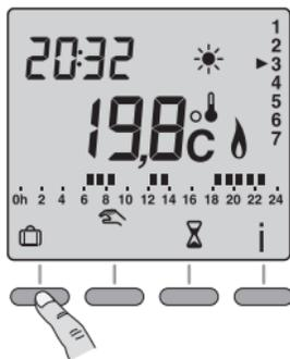
Dieser Modus wird angewendet, um die Temperatur im Bereich von 5°C bis 15°C einzustellen, bei einer Abwesenheit von 1 bis 365 Tagen.
