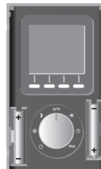
Batterien wieder richtig einsetzen und die Hülle auf die Steuerung aufsetzen.
