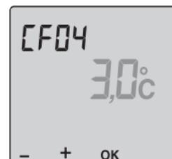
Einstellung von 1°C bis 6°C, in 0,1°C Schritten. Falls die Temperatur zu früh erreicht wird, verringern Sie den Wert. Wird die Temperatur zu spät erreicht, erhöhen Sie den Wert. Der Standardwert ist 3,0°C.
