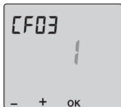
Adaptiv Start bedeutet, dass das Gerät mit dem Aufheizen früher beginnt, so dass die eingestellte Temperatur bereits zu der im Zeitplan festgelegten Zeit erreicht ist und das Aufheizen nicht erst dann beginnt (Wechsel Eco ▶ Komfort).
