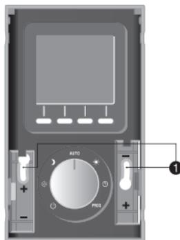
Das Panel mit Schrauben und Dübeln an der Wand befestigen (Lochabstand 60 mm).
