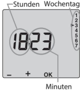
Drehen Sie den Regler auf. Die Wochentage fangen an zu blinken. Mit den Tasten + und – den beliebigen Tag auswählen und mit OK bestätigen um fortzufahren. Den Vorgang mehrmals wiederholen, um die aktuellen Stunden und Minuten einzustellen. Mit dem Drehen des Reglers den Vorgang abschließen.
