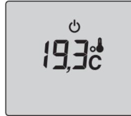
Um die Fernsteuerung auszuschalten, drehen Sie den Regler OFF. Auf dem Display wird die aktuell gemessene Raumtemperatur angezeigt.
