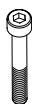
Vidat e mbështetëses 4EA, M6 x L45 (Vetëm 65UB98**) (Shikoni f. A-5)
