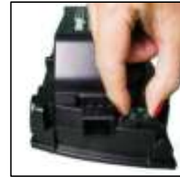
Figuur 65 Vervangen van zekering
