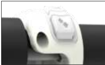
Figuur 27 Rijrichting en claxon knoppen
