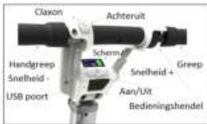
Figuur 23 Overzicht bedieningspaneel
