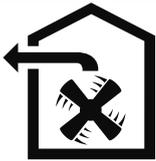
El aire no se puede desviar a una chimenea que se use para los gases residuales del aparato que queman gas u otros combustibles (esto no se aplica a los aparatos de recirculación de aire).
