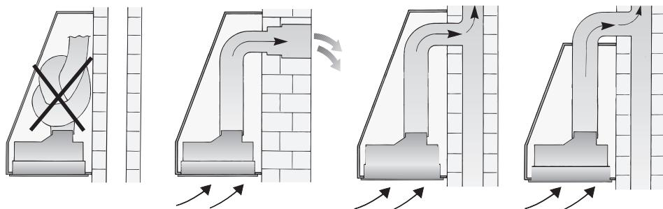
L'air vicié est évacué vers le haut par un conduit d'aération ou directement à l'air libre par traversée du mur extérieur.
