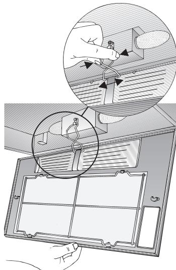
3. Retirar la rejilla de alambre; sustituir la esterilla filtrante usada por una nueva.
