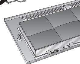
2. Stendere il filtro a carbone attivo sulla stuoia filtrante e bloccarlo.
