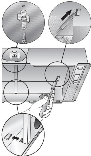
4. Incollare il filtro a carbone attivo con l'accusolo nastro di tenuta.
