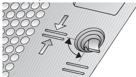
2. Drücken Sie die Sicherungsfeder und nehmen Sie den Filterrahmen ab.
