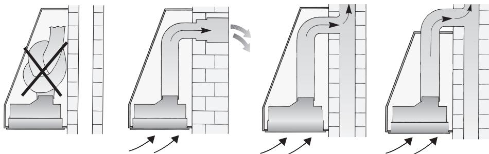
Die Abluft wird über einen Lüftungsschacht nach oben, oder direkt durch die Außenwand ins Freie geleitet.
