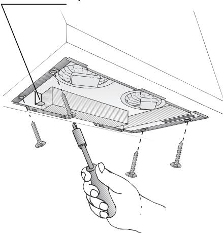
3. Retirar la **campana extractora** del hueco de montaje tirando de la misma hacia abajo.
