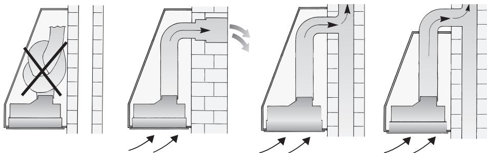
L'aria di scarico viene condotta verso l'alto, attraverso un pozzo di ventilazione, oppure direttamente all'aperto, attraverso la parete esterna.
