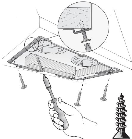
5. **Filterrooster** aanbrengen en vergrendelen (zie gebruiksaanwijzing).
