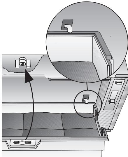
6. Setzen Sie die zwei Filterkassetten wieder ein.
