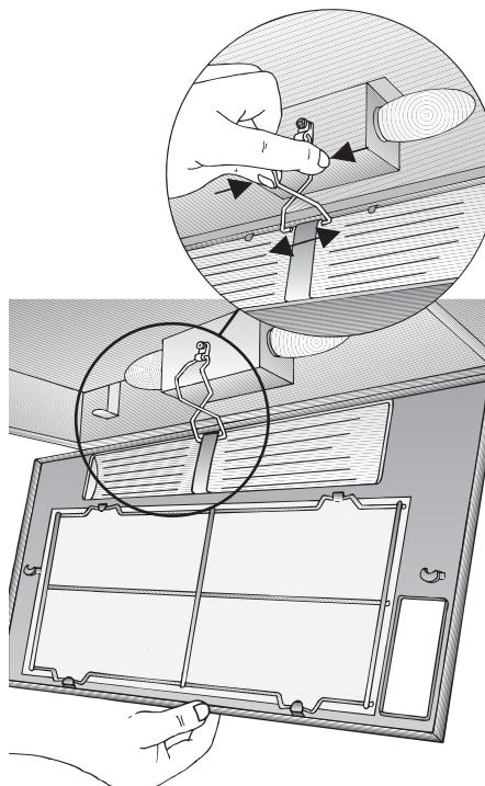
3. Entfernen Sie das Drahtgitter und tauschen Sie die Filtermatte aus.
