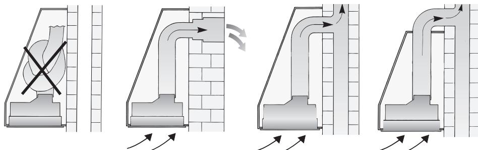
Os vapores são encaminhados para o exterior através de um canal de ventilação ou directamente através de furo na parede, para o exterior.
