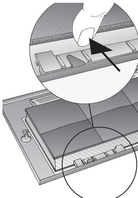
3. Monteren van het filterframe.
