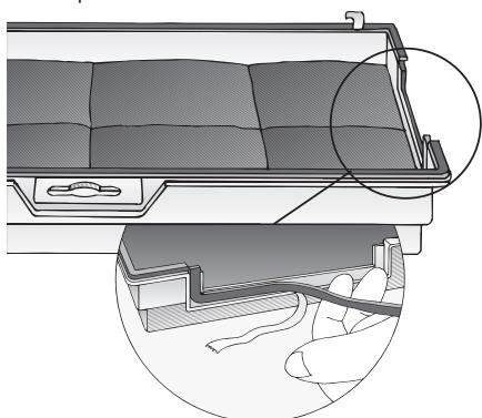
5. Colocar el filtro de carbón activo en su emplazamiento, comenzando por la parte posterior; desplazarlo hacia arriba y fijarlo en el centro con la tuerca de mariposa. En caso de haber retirado la regleta distanciadora, volverla a montar en su sitio.
