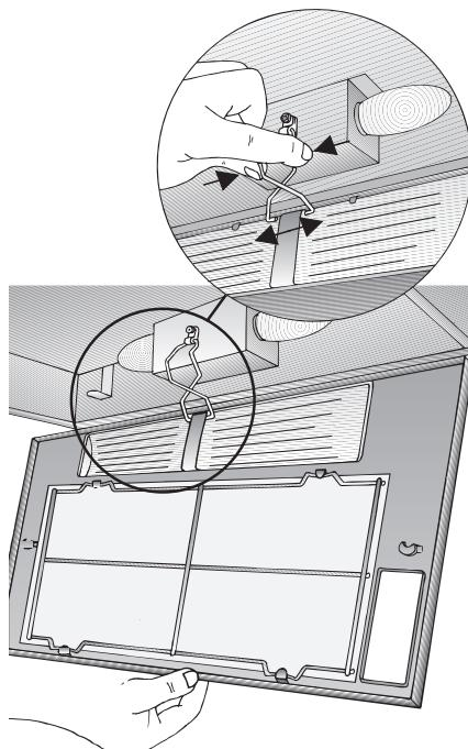
3. Rimuovere la rete di filo metallico e sostituire la stuoia filtrante.
