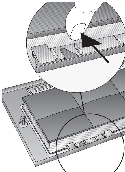
3. Montieren des Filterrahmens.
