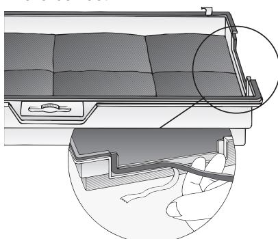
5. Introduisez l'arrière du filtre à charbon actif, soulevez le filtre puis verrouillez-le au milieu par l'écrou à ailettes.
