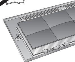
2. Coloque el filtro de carbón sobre la esterilla filtrante, aprisionándolo en la misma.
