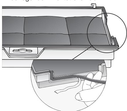
5. Setzen Sie den Aktivkohlefilter hinten ein, klappen Sie ihn hoch und verriegeln ihn in der Mitte mit der Flügelmutter. Wurde die Distanzschiene entfernt, müssen Sie diese wieder einsetzen.
