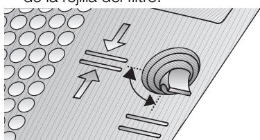
2. Presionar y desenganchar el muelle de sujeción de su emplazamiento; desmontar a continuación el marco del filtro.
