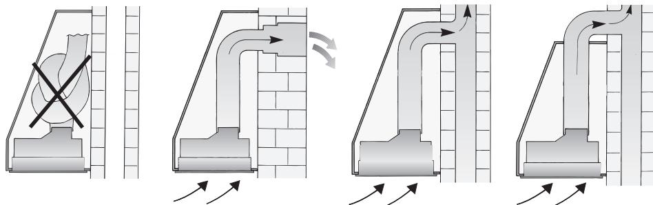
El aire de evacuación pasa a través de un túnel de ventilación hacia arriba o directamente hacia el exterior, a través de la correspondiente pared.
