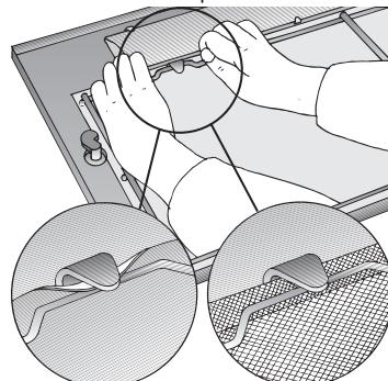
4. Montar el marco del filtro ejecutando las operaciones correspondientes en el orden inverso al seguido para su desmontaje.
