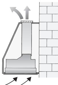
Die durch einen zusätzlichen Aktivkohlefilter gereinigt Luft wird wieder in den Raum zurückgeführt.
