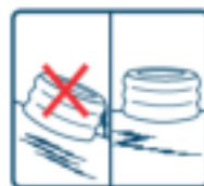
Un emplacement de niveau
