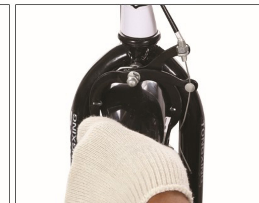
18. Knijp de voorrem bij mekaar en trek de remkabel aan
