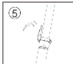
3. Tournez les poignées dans le sens des fils comme indiqué. (Vérifiez toujours avant de conduire que les poignées du guidon soient bien serrées et non desserrées, puis serrez fermement)
