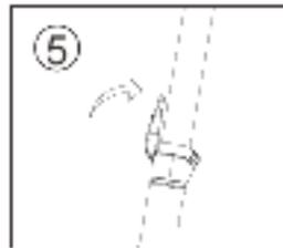
3. Draai de handvatten in de richting van de schroefdraad, zoals afgebeeld. (Controleer altijd voordat u gaat rijden of de handvatten stevig zijn aangedraaid en niet los zitten, draai ze, indien nodig, stevig aan)
