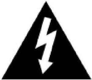
La figura de relámpago y punta de flecha en el interior del triángulo es una señal de advertencia del "voltaje peligroso" dentro de este producto.
