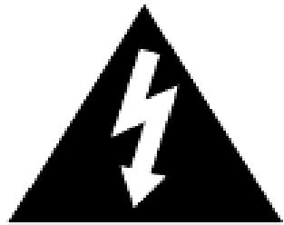
De bliksemschicht met pijlpunt in een driehoekig vlak is een waarschuwingssymbool dat aangeeft dat het apparaat werkt met een gevaarlijke hoge spanning.
