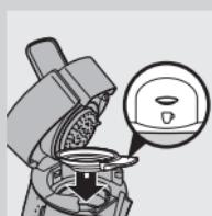
**U kunt de machine niet ontkalken als het deksel niet goed is gesloten en de hendel van het deksel niet is vergrendeld. Als dit het geval is, knippert het indicatielampje met tussenpozen.**
