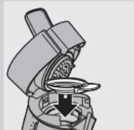
**1** Vul het waterreservoir met koud water tot boven het MIN-niveau en plaats het terug in de machine.
