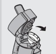
**4** Retirez l'unité d'écoulement du café de l'appareil en la faisant glisser vers le haut.
