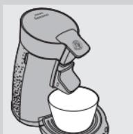
*Remarque : Utilisez toujours une coffee pad usagée lors du détartrage de la cafetière. Celle-ci filtre les résidus de calcaire pour éviter que le tamis ou l'orifice du support à coffee pad ne se bouchent.*
