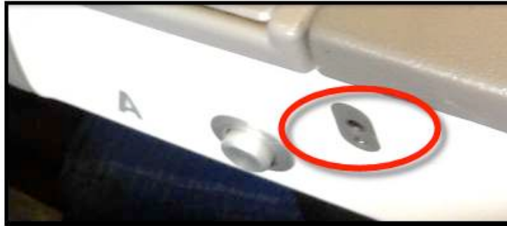
図 1.9 – 機内シート (アームレスト) の入力ジャック
