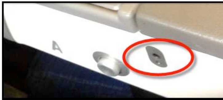
Hình 1.9 – Giắc đầu vào trên ghế ngồi của máy bay (Phần kê tay)
