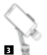
Abb. 3 Kippt das Smartphone nach rechts, müssen Sie das Smartphone in der Halterung soweit nach links schieben, bis es gerade ausbalanciert ist. Dies muss bei Einsatz des iPhone 5 / 5s und ähnlichen Android Smartphones vorgenommen werden.
