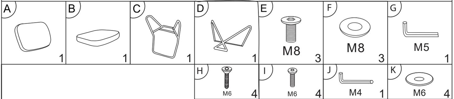
**Stap 1:** Verwijder het verpakkingsmateriaal. Zet onderdelen (C) en (D) op elkaar en zorg dat de schroefgaten overeen komen. Monteer met de schroeven (E) met daaronder de sluitringen (F). Draai aan met de inbusleutel (G).
