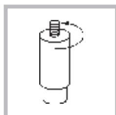
Si es necesario nivelar el aparato, enrosque las patas de regulación suministradas con el aparato, en los ángulos de la base de la cocina (ver la figura).
