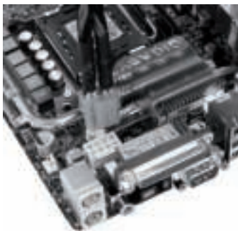
Connecteur ATX12V 4+4 combiné (image de gauche) et séparé (image de droite)
