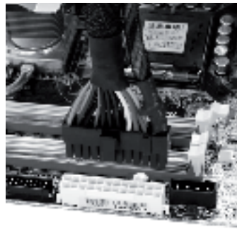
Connecteur ATX 20+4 avec connecteur à 4 broches séparées (image de gauche) et attachées (image de droite)
