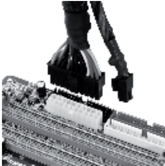
Conector ATX 20+4 con conector de 4 clavijas separadas (imagen izquierda) y unidas (imagen derecha)
