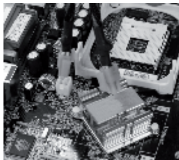
ATX12V 4+4 csatlakozó (bal oldali kép) kombinálva (bal oldali kép) és leválasztva (jobb oldali kép)
