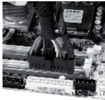
ATX 20+4 csatlakozó 4-tűs csatlakozóval, leválasztva (bal oldali kép) és csatlakoztatva (jobb oldali kép)
