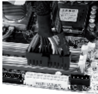
Conector ATX 20+4 con conector de 4 clavijas separadas (imagen izquierda) y unidas (imagen derecha)
