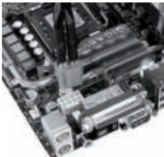
ATX12V 4+4 -liitin liitettynä (kuva vasemmalla) ja irrotettuna (kuva oikealla).
