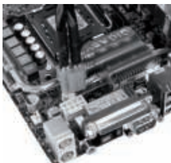
Conector ATX12V 4+4 combinat (poza din stânga) și separat (poza din dreapta).
