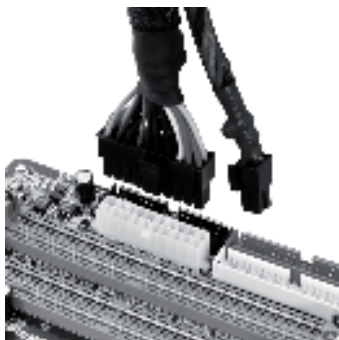
Conector ATX 20+4 cu 4 pini, separat (poza din stânga) și combinat (poza din dreapta).
