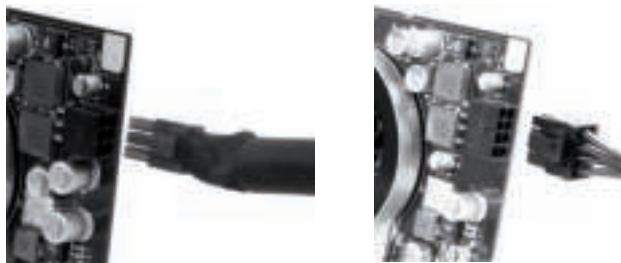
Connettore PCI-E 6+2 pin con connettore a 2 pin non inserito (immagine a sinistra) e inserito (immagine a destra) per la scheda VGA
