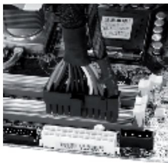
Conector ATX 20+4 cu 4 pini, separat (poza din stânga) și combinat (poza din dreapta).
