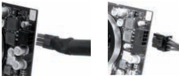
6+2-poliger PCI-E-Stecker einzeln (linkes Bild) und montiert (rechtes Bild) für die VGA-Karte
