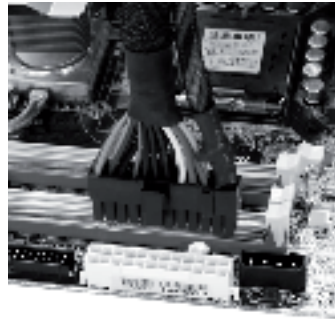
ATX 20+4 -liitin erillisellä 4 piikkisellä liittimellä (kuva vasemmalla) ja liitetty (kuva oikealla).
