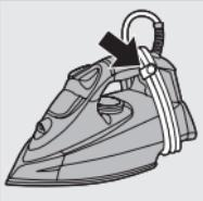
**Μην χρησιμοποιείτε το αντιθερμικό προστατευτικό κάλυμμα κατά τη διάρκεια του σιδερώματος.**
