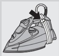
**4** Τυλίξτε το καλώδιο του ρεύματος γύρω από το χώρο αποθήκευσης καλωδίου και στερεώστε το με το κλιπ καλωδίου.
