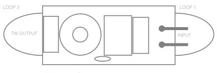
No loop cut : 0dB Cut loop 1 : -2.5dB Cut loop 2 : -3.5dB Cut loop 1 and loop 2 : -6dB
