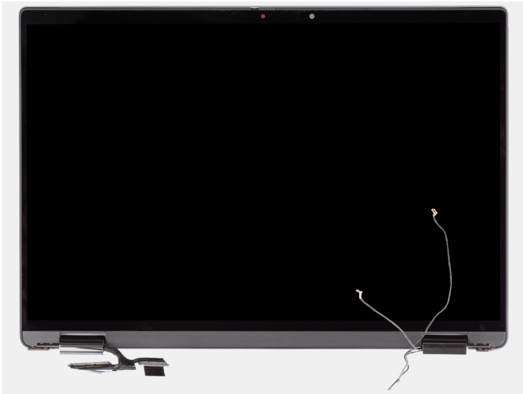
Afbeelding 1. Beeldschermeenheid met WWAN-antennekabels
