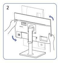
Drehen Sie das Gerät in die höchste vertikale Position.
